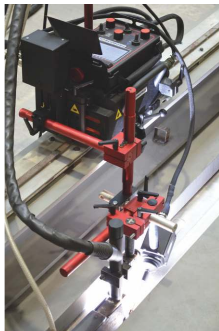
Отслеживание швов работает как с колебаниями, так и без них
