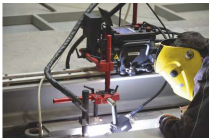
Сварка титановой пластины TIG
